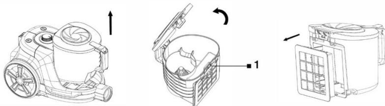
3. Drücken Sie den Riegel, um das Magazin ( 1 ) zu öffnen und den Schmutz und Staub zu entleeren.
